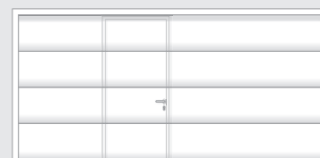
Symmetrische Anordnung bei BRB 2.000 - 3.500 mm – nur mittig
