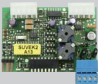
Empfänger für Fernbedien- ung (auch lieferbar in Gehäuse)
