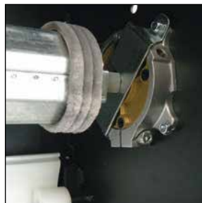
Mechanische Absturzicherung bei Übergeschwindigkeit
