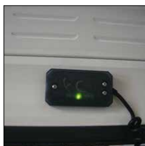
Optische Schließkantensicherung mit LED-Betriebsanzeige, im Werk vormontiert
